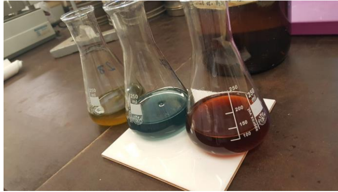
18. ábra Titrálás közbeni színváltozások; Fotó: Sósne Mező Krisztina
