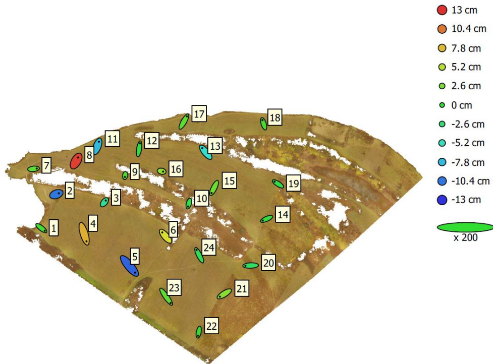
23. ábra GCP-k hibaértékei a mintaterületen szemléltetve
