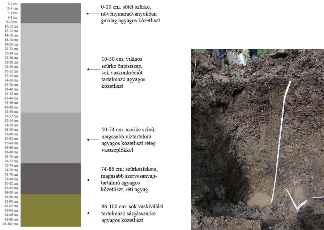
26. ábra Horgony I. szelvény rétegtani vázlata (saját szerkesztés, saját fotó)
