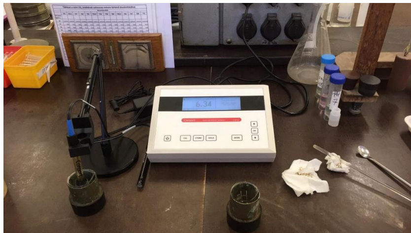
19. ábra pH meghatározása digitális pH mérővel (saját fotó)
